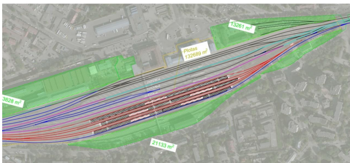
29 pav. Vilniaus keleivių GS 1435 mm kelių išdėstymas ir 1520 mm kelio sąsaja
