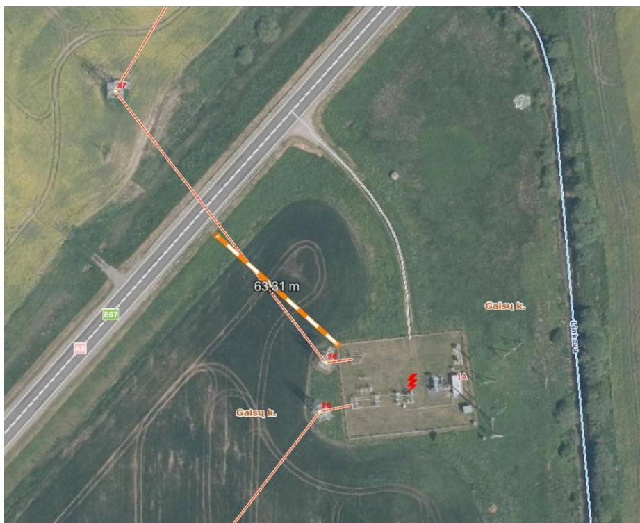
5-1 pav. Transformatorinės atstumas iki kelio A8 ribos (šaltinis; https://regia.lt/ [žiūrėta: 2025-05-12])
