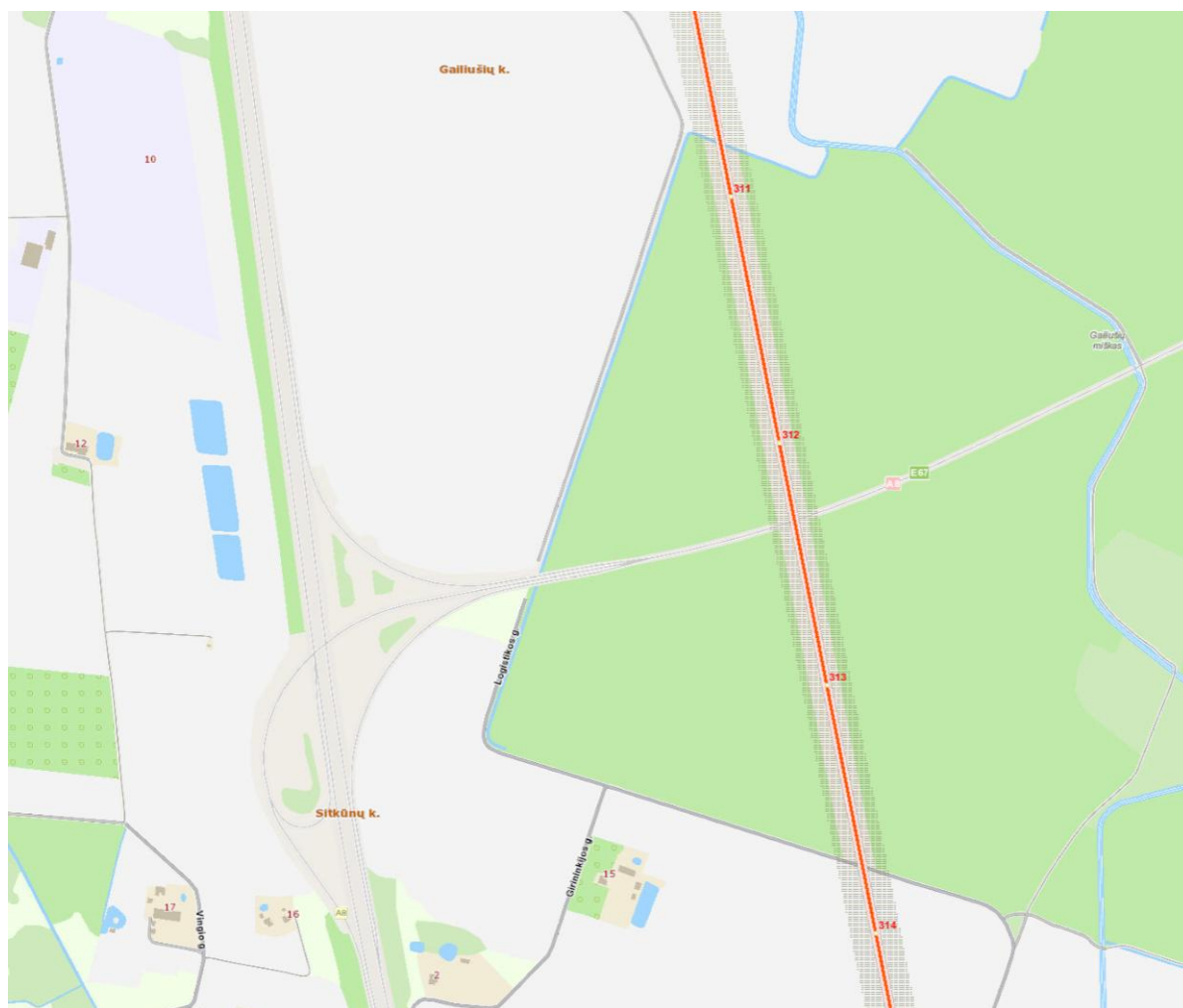
5-2 pav. 330 kV aukštos įtampos elektros oro linijos ir kelio A8 sankirta ties Sitkūnais (ištrauka iš https://regia.lt/ [žiūrėta:2025-05-12])
