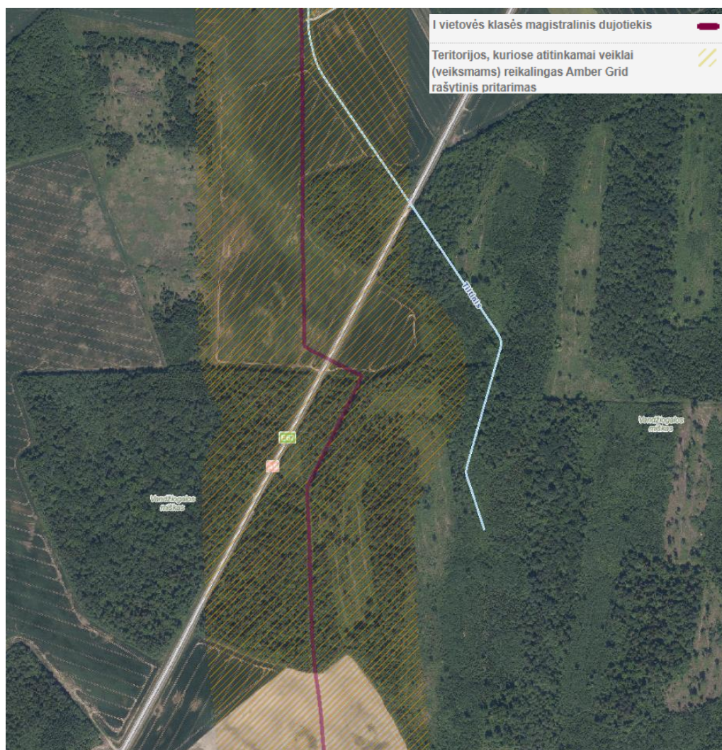
5-12 pav. Magistralinio dujotiekis vamzdyno ir jo apsaugos zona (ištrauka iš https://regia.lt/ [žiūrėta: 2025-05-12])
