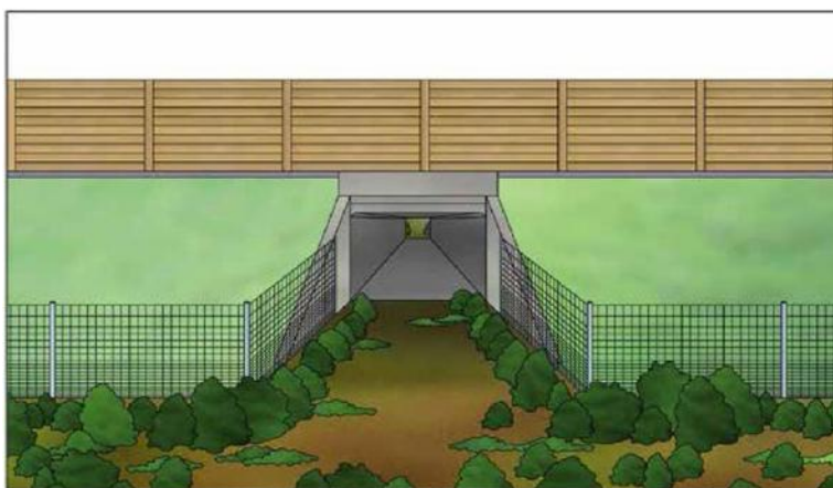
17 pav. Tinkamai aptvertos požeminės perėjos žinduoliams schema (Potenciano ir kt., 2016)
