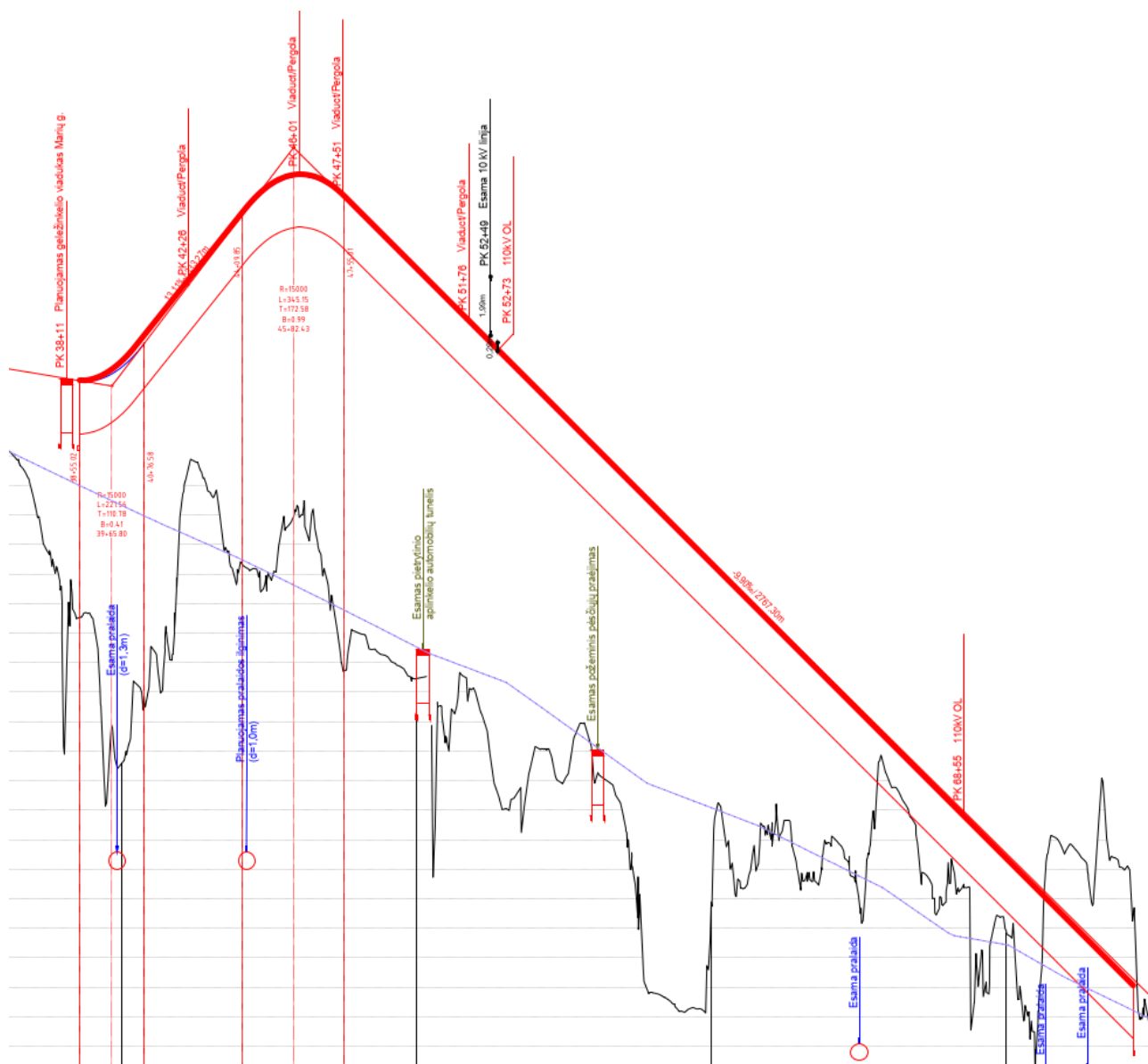
43 pav. Planuojamo geležinkelio viaduko Palemone išilginis profilis
