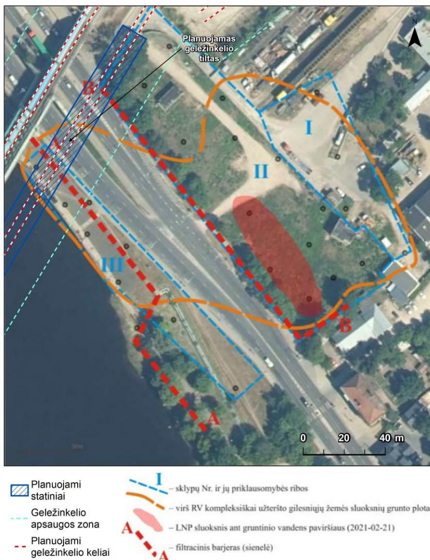
21 pav. Užteršta teritorija Juozapavičiaus per. 118 ir 120 ir filtracinių barjerų įrengimo vieta
