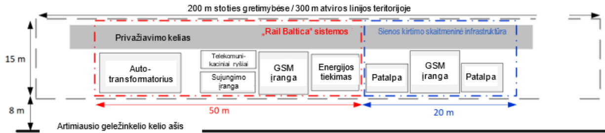
Pav. 29. Blokposto dalis, skirta sistemų įrangai
